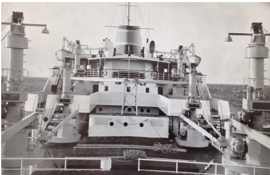
Fartyget fotograferat akterifrån. Foto från Hans Neréns samling. Observera de äldre luckorna innan ombyggnaden till Mc Gregor patentluckor.
